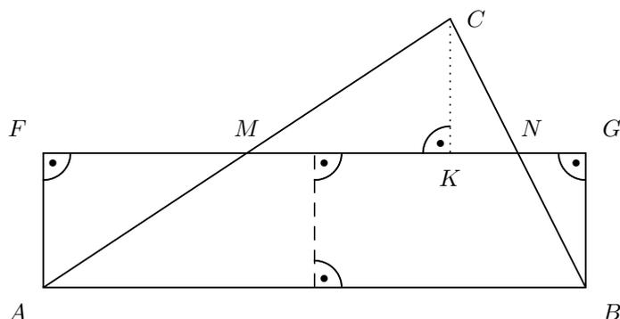
Die Mittellinie des Saccheri-Vierecks steht auf der Basis und der Gipfelinie senkrecht. Daraus folgt, dass die Basis  $\overline{GF}$  und die Gipfelinie  $\overline{BA}$  parallel sind.
