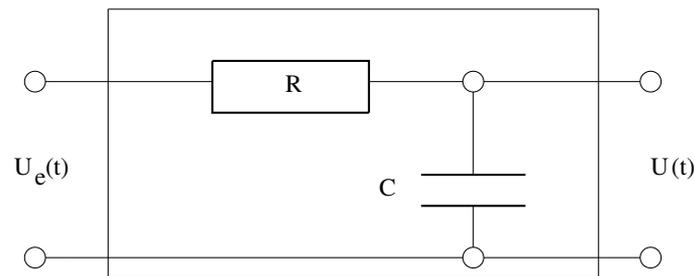
Es wird eine stückweise stetige  $T$ -periodische Eingangsspannung  $U_e(t)$  angelegt, die durch ihre Fourierreihe  $U_e(t) = \sum_{k \in \mathbb{Z}} c_k \cdot e^{j\omega k t}$  gegeben ist. Als Ausgangsspannung ergibt sich (wie in der Vorlesung gesehen):
