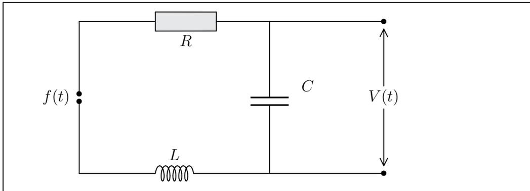
Wir analysieren einen Stromkreis aus Widerstand  $R$ , Induktivität  $L$  und Kapazität  $C$ . Gefragt ist nach der Ausgangs-Spannung  $V$  am Kondensator, wenn die Eingangs-Spannung  $f$  angelegt wird.
