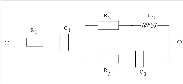
Die Serienschaltung aus  $R_2$  und der Spule hat den Widerstand  $\underline{Z}_2 = R_2 + \mathbf{j}\omega L_2$ , die Serienschaltung aus  $R_3$  und dem Kondensator mit Kapazität  $C_3$  den Widerstand  $\underline{Z}_3 = R_3 - \mathbf{j}/\omega C_3$ . Die Parallelschaltung von beiden Serienschaltungen hat also den Widerstand
