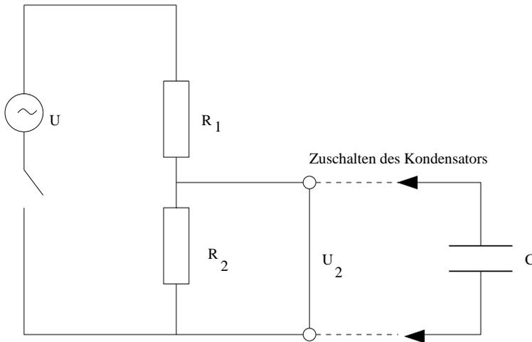
Wir untersuchen zuerst den „unbelasteten“ Fall, also den Fall, in dem der Kondensator nicht mit  $R_2$  parallel geschaltet ist.
