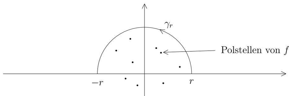
Der Weg  $\gamma$  sei zusammengesetzt aus der Strecke zwischen  $-r$  und  $r$  auf der reellen Achse und dem Halbkreis  $\gamma_r(t) := re^{jt}$ ,  $0 \leq t \leq \pi$ . Dann ist
