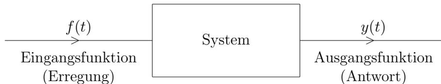
Unter dem „System“ ist häufig ein elektrisches Netzwerk zu verstehen. Die Eingangsfunktion ist normalerweise eine stückweise stetige  $L$ -Funktion, kann aber auch eine Distribution sein. Dementsprechend ist auch die Systemantwort eine Funktion oder eine Distribution.
