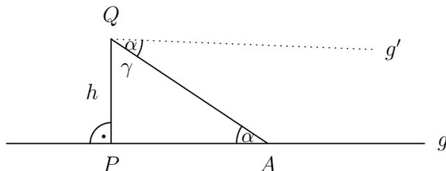
Trägt man  $\alpha := \angle PAQ$  bei  $Q$  an  $QA$  an, so erhält man eine Gerade  $g'$ , die wegen der Z-Winkel-Beziehung parallel zu  $g$  ist. Da die Winkelsumme im Dreieck  $PAQ$  kleiner als zwei Rechte sein muss, ist  $\alpha + \gamma < 90^\circ$ , also schneidet  $g'$   $h$  in einem spitzen Winkel. ■
