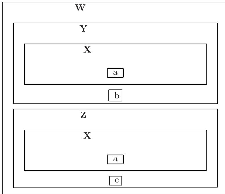
Es werden mehrere Basisklassen(sub)objekte erzeugt. Will man dies nicht, so muss man virtuelle Basisklassen verwenden.
