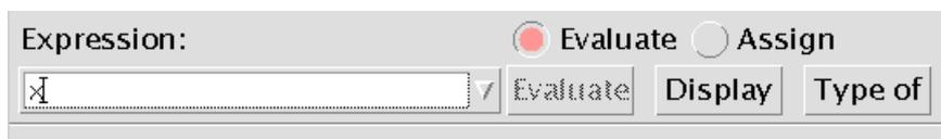
Durch Klick auf den `Display`-Button öffnet sich ein Fenster mit dem Titel `WorkShop Data Display`. Wenn das Programm gerade nicht läuft, steht im Fenster `x = <not active>`.
