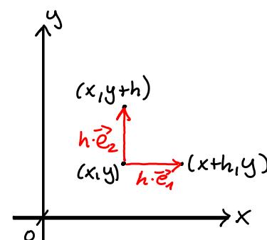
Wir lassen nun auch andere Richtungsvektoren  $\vec{v} = \begin{pmatrix} v_1 \\ v_2 \end{pmatrix}$  mit  $|\vec{v}| = \sqrt{v_1^2 + v_2^2} = 1$  zu. Damit ergibt sich verallgemeinernd folgende Definition für die Richtungsableitung, d.h. für die momentane Änderungsrate einer Funktion bzgl.  $\vec{v}$  mit  $|\vec{v}| = 1$ .
