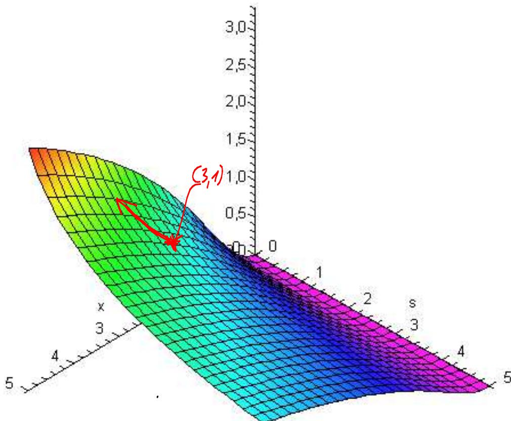
Eine weitere Eigenschaft des Gradienten erschließt sich mit Hilfe folgender Überlegung. Zeigt  $\vec{v}$  in Richtung der Tangenten einer Niveaulinie, so ist die Richtungsableitung in Richtung von  $\vec{v}$  gleich Null, da sich der Funktionswert auf einer Niveaulinie nicht ändert. In diesem Fall ist also
