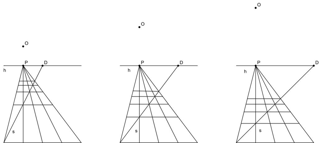
Es ist  $d(O, h) = |PD|$ . Der Distanzpunkt ist der Fluchtpunkt der Bilder aller Geraden, welche mit der Standlinie einen  $45^\circ$ -Winkel bilden.
