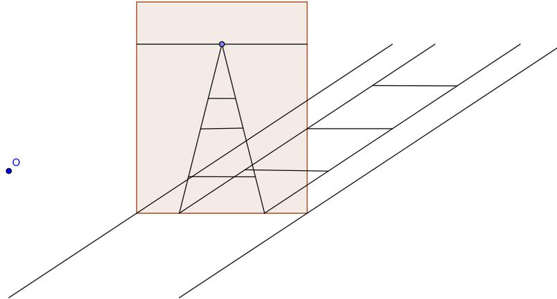
Ausgenommen hiervon sind Parallelen der Objektebene, welche parallel zur Standlinie verlaufen. Diese werden auf parallele Geraden der Bildebene, parallel zur Standlinie, abgebildet.
