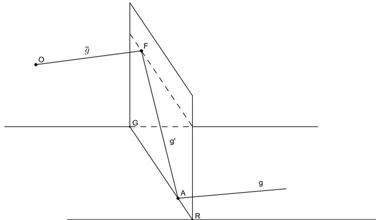
Der Fluchtpunkt  $F$ , der zur Bildgeraden  $g'$  von  $g$  gehört, ist natürlich nichts anderes als der Schnittpunkt von  $g'$  mit dem Horizont.  $g'$  findet man - theoretisch - indem man die Ebene durch  $O$  und  $g$  legt und diese mit der Bildebene schneidet. Konstruktiv ergibt sich  $F$ , indem man durch  $O$  in der von  $O$  und dem Horizont festgelegten Ebene die Parallele  $\bar{g}$  zu  $g$  zieht. Deren Schnittpunkt mit dem Horizont ist der gesuchte Fluchtpunkt  $F$ .
