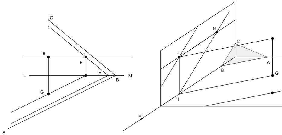
Eine symmetrische Lösung ergibt sich, wenn man durch  $G$  die Parallele zur Rissachse zieht. Dann legt man durch  $g$  die Parallele zu  $BC$ , erhält deren Schnittpunkt  $H$  mit der Rissachse und errichtet in  $H$  die Senkrechte auf der Rissachse in der Grundrissebene. Deren Schnittpunkt mit der Parallelen durch  $G$  sei  $D$ .  $D$  legt dann die Spurgeraden fest. ■
