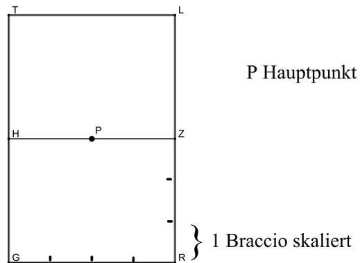
Da der Rahmen - das Bild - i.a. deutlich kleiner ist in seinen Abmessungen als das Muster in der Objektebene, verkleinert („skaliert“) man die Einheit (hier „Braccio“) z.B. auf ein Zehntel.
