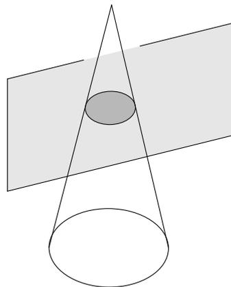
Bei der Parallelprojektion treten an die Stelle von Pyramiden und Kegeln Prismen und Zylinder.
