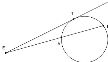
Nach dem Satz über Sekantenabschnitte (III 36) ist das Produkt  $EA \cdot EB$  konstant gleich  $ET^2$  (natürlich nur solange, als es Schnittpunkte  $A$  und  $B$  gibt). Bezeichnet  $r$  den Radius des Kreises und  $d$  den Abstand des Punktes  $E$  vom Mittelpunkt des Kreises, so gilt:
