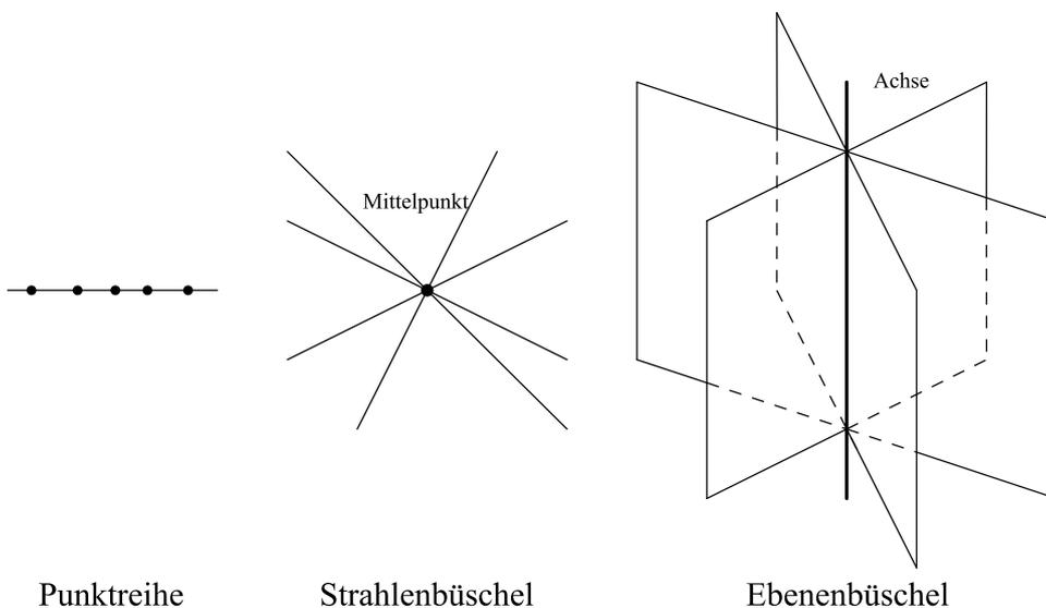
Nimmt man aus einer Punktreihe zwei Punkte heraus, so begrenzen diese eine Strecke, nimmt man zwei Strahlen aus einem Strahlenbüschel so ergibt sich ein Winkel (genauer gesagt: zwei Paare von Scheitelwinkeln, welche jeweils Nebenwinkel zu einander sind) und wählt man aus einem Ebenenbüschel zwei Ebenen aus, so legen diese einen Flächenwinkel (hier gilt dieselbe Bemerkung wie bei den gewöhnlichen Winkeln) fest.
