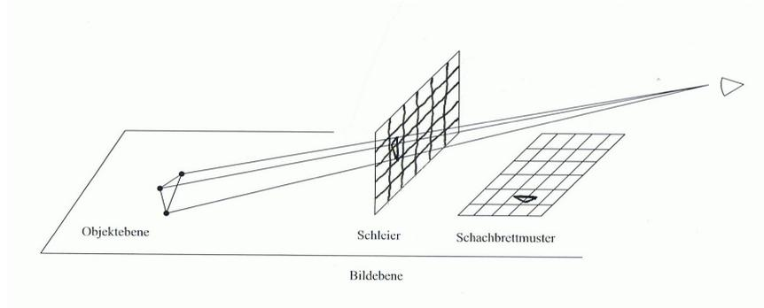
Der Schleier dient dazu, die Bildpunkte zu lokalisieren. Diese werden in das Schachbrettmuster (Gitter) übertragen. Offensichtlich werden hier implizit Koordinaten verwendet.
