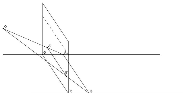
Da  $AB$  parallel zu  $GR$  ist, kann man durch  $AB$  eine Ebene  $e$  legen, welche parallel zur Bildebene ist. Die von  $O$  ausgehenden Strahlen  $OA$  und  $OB$  werden durch diese Ebene in  $A, A', B$  und  $B'$  geschnitten. Dann gilt nach einer räumlichen Fassung des Strahlensatzes (XI,17: „Werden zwei Geraden von parallelen Ebenen geschnitten, so müssen sie in denselben Verhältnissen geteilt werden“):
