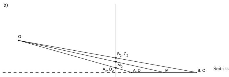
Die „Koordinaten“ aus a) und b) werden mit Hilfe eines Streifens, auf dem man Markierungen anbringt, nach c) übertragen:
