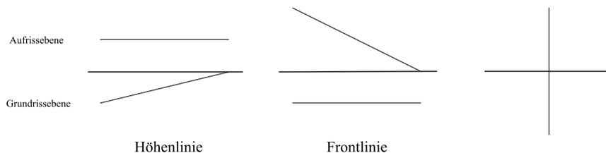
Eine Gerade schließlich, deren beiden Projektionen parallel zur Rissachse sind, ist eine, die selbst parallel zur Rissachse ist. Sie ist sowohl Höhen- als auch Frontlinie.
