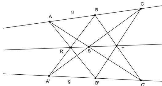
Der Satz gilt auch, wenn  $g$  und  $g'$  parallel sind. Eine andere Formulierung, die oft als Satz von Pappos bezeichnet wird ist folgende (Voraussetzungen und Bezeichnungen wie oben): Ist  $AC'$  parallel zu  $A'C$  und  $B'C$  parallel zu  $BC'$ , so ist auch  $AB'$  parallel zu  $A'B$ .
