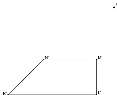
Errichte in  $K'$  und  $L'$  die Senkrechten auf  $K'L'$ . Trage hierauf die Länge  $a$  der ursprünglichen Würfelkante ab. Endpunkte seien  $Q'$  und  $R'$  mit  $P$ . Errichte in  $M'$  und  $N'$  die Senkrechten auf  $M'N'$ . Schnittpunkte mit  $Q'P$  und  $R'P$  seien  $S'$  und  $T'$ .
