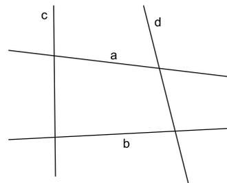
**Bezeichnung:** Beim Viereck werden zwei Seiten, die nicht durch ein und denselben Eckpunkt gehen, **Gegenseiten** genannt. Paare von Gegenseiten sind also (siehe oben):  $AB, CD$  sowie  $AD, BC$  und  $AC, BD$ . Die Schnittpunkte der Gegenseiten heißen **Nebeneckpunkte** (auch Diagonalepunkte ist üblich [vor allem im Englischen]).
