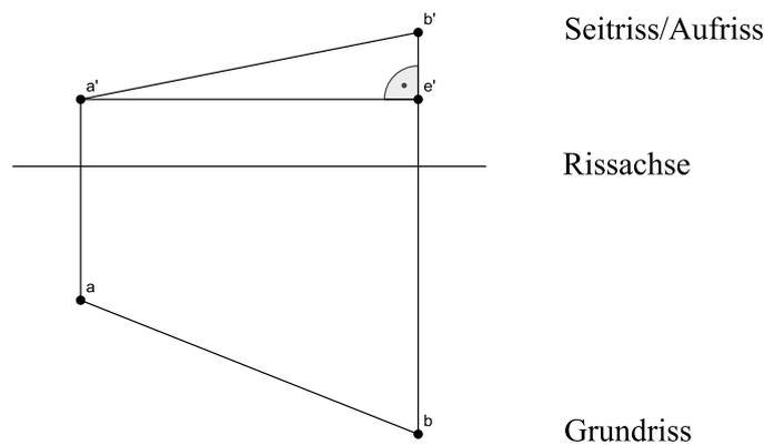
Zuerst konstruiert man in der Seitriseebene den Punkt  $e'$  und damit die Strecke  $b'e'$ . Von  $e'$  aus trägt man auf der Geraden  $a'e'$  in Richtung  $a'$  die Strecke  $ab$  aus der Grundrissebene ab. Deren Endpunkt sei  $H$ . Dann verbinde man  $H$  mit  $b'$ . Die Länge der Strecke  $Hb'$  ist gleich der Länge der Strecke  $AB$ .
