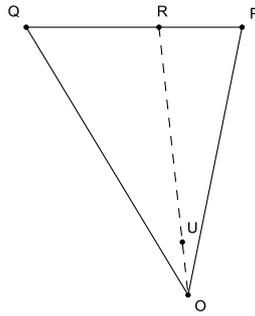
Wir werden die Bildebene wie oben senkrecht zur Objektebene stellen und zwar so, dass die Standlinie parallel zur Geraden  $PQ$  verläuft. Der Augpunkt ist dann in derjenigen Ebene zu nehmen, die die Objektebene senkrecht in  $PQ$  schneidet.
