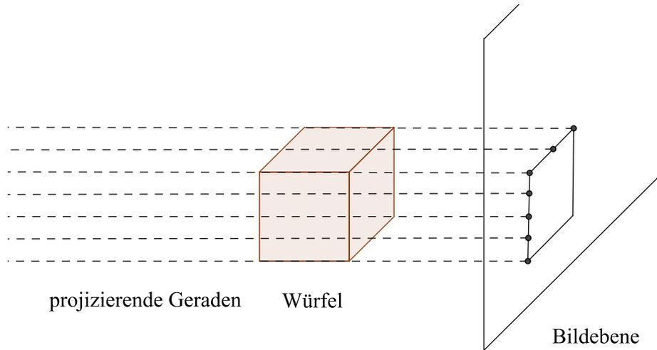
Stehen die projizierenden Strahlen senkrecht auf der Bildebene, so liegt eine orthogonale Parallelprojektion vor, sonst eine schräge. Orthogonale Parallelprojektionen sind in der Technik sehr wichtig, denn sie bilden Strecken, die parallel zur Bildebene liegen, längentreu ab.
