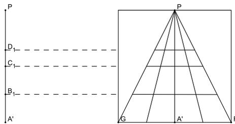
Mit Hilfe des Gitternetzes kann man Bilder anderer Figuren konstruieren, z.B. ins Gitternetz eingezeichnete Rechtecke oder den perspektivischen Mittelpunkt eines Quadrats oder Rechtecks.
