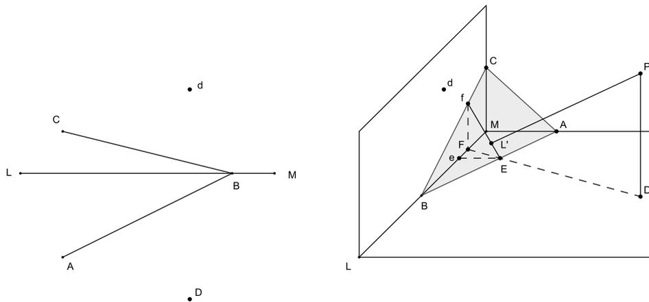
**Analysis:** Sei  $PL'$  das gesuchte Lot. Betrachte die Ebene durch  $L', P$  und  $D$ . Diese steht senkrecht auf der Grundrissebene und senkrecht auf der gegebenen Ebene. Der Schnitt der Grundrissebene mit der Ebene durch  $L, P$  und  $D$  sei  $ED$ . Dann ist  $ED$  die Projektion von  $LP$  in die Grundrissebene. Analog findet sich die andere Projektion.
