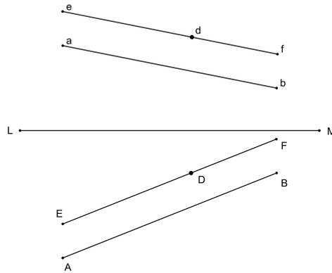
Die zweite Aufgabe ist das analoge Problem für Ebenen: Es sei eine Ebene gegeben, deren Spurgeraden  $AB, BC$  seien und ein Punkt mit den Projektionen  $G, g$ . Es sollen die Spurgeraden derjenigen Ebene konstruiert werden, die durch den Punkt geht und parallel zur ersten Ebene ist (Monge 1799, 22).
