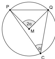
Insbesondere ist der Peripheriewinkel für alle  $C$  im gleichen Kreisbogen gleich.
