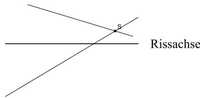
Spurpunkte sind die Punkte, in denen eine Gerade („in allgemeiner Lage“) die Rissebene schneidet ( $D_1$  und  $D_2$  oben). Aus der Zwei-Tafel-Darstellung einer Geraden kann man die Spurpunkte rekonstruieren.
